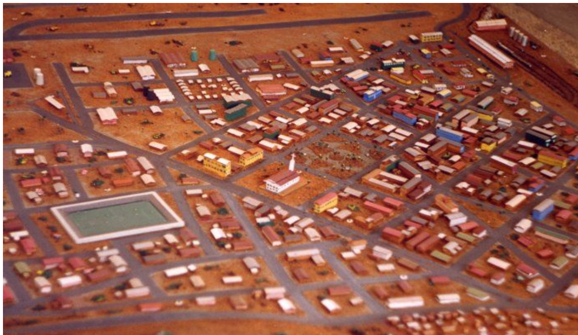
Figura 1: Maquete existente no Departamento de Geomática da UFPR usada pelos alunos para simulações de levantamentos aerofotogramétricos
