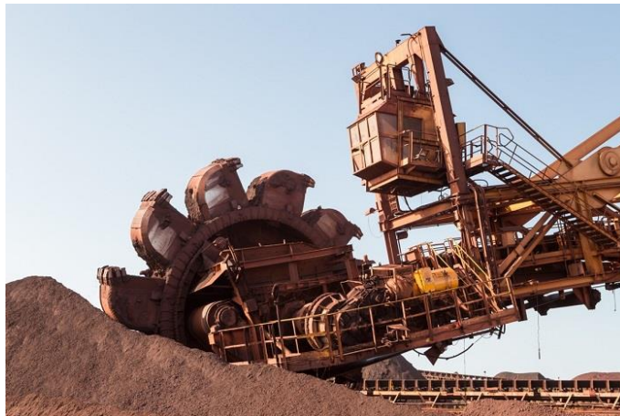
Figura 6: Recuperadora de minério
