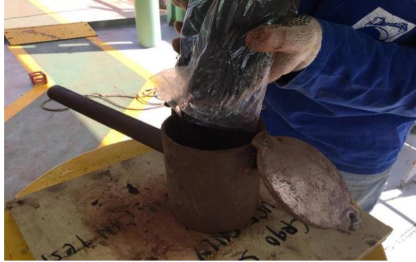
Figura 22: Lata sendo preenchida pela amostra retirada
