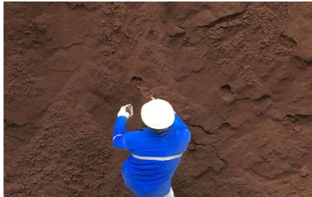
Figura 21: Amostra sendo retirada do minério já embarcado
