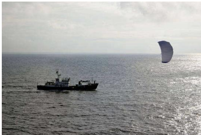
Figura 13: Foto do navio Beluga equipado com propulsão auxiliar por kite.
