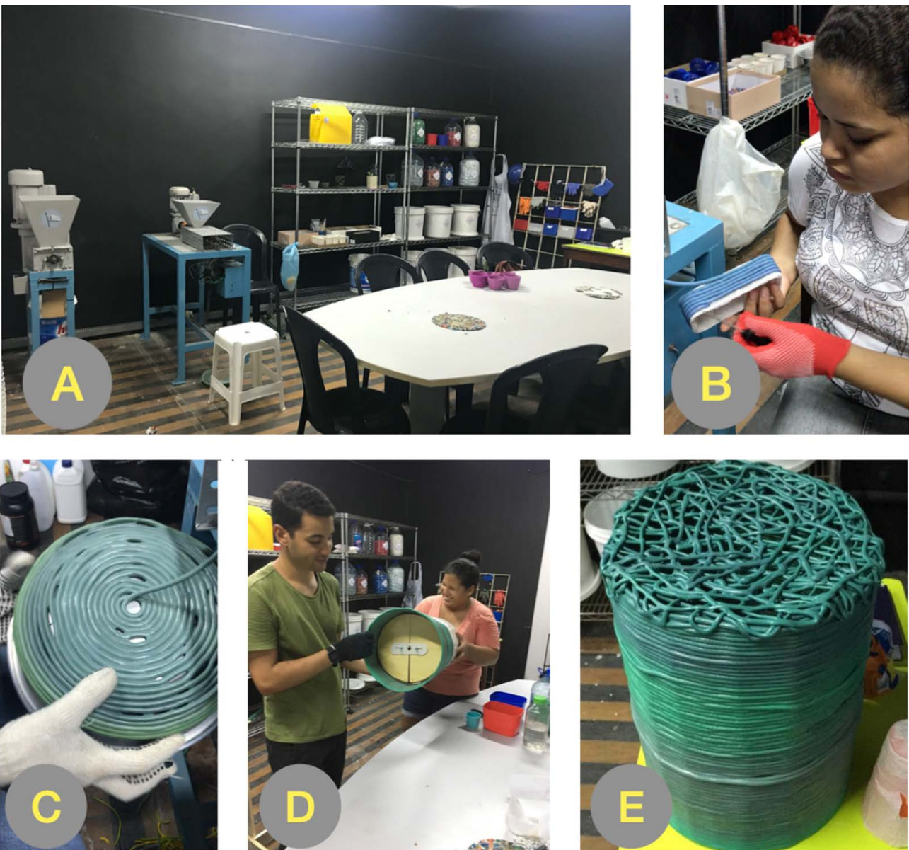
Figura 2 – (A) laboratório de reciclagem instalado na comunidade do Pilar, resultado da parceria entre o Laboratório Grea3D (UFPE) e a ONG Instituição Plano B; (B/C) uso da extrusora de plástico para desenvolvimento de saboneteira e fruteira; (D) uso de molde para desenvolvimento de lixeira; (E) produto final: lixeira
