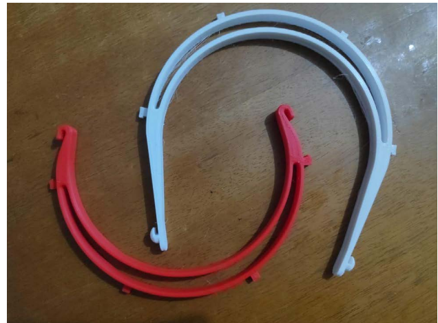
Figura 9 – Haste do projeto Hígia, em branco, e haste do projeto Fabricac, em vermelho
