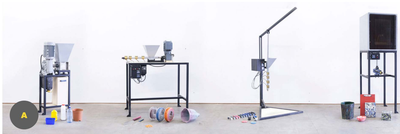
Figura 1 – Equipamentos de reciclagem de plástico. Informações para iniciar seu projeto de reciclagem: pontos de coleta de material, venda de equipamentos, espaço de trabalho utilizando as máquinas trituradora, extrusora, prensa e injetora
